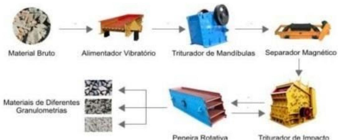
Figura 25. Esquema de uma usina de reciclagem de RCC's.
